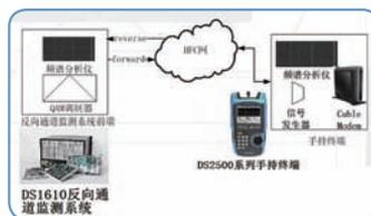
图3.14 反向通道监测系统联调示意图
